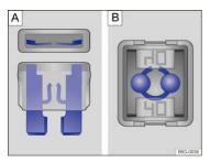
Fig. 204 Blown fuse: : Blade fuse. : Cartridge fuse.
