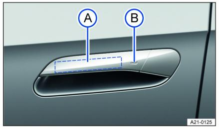
Fig. 44 In door handle: sensors.
