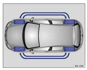
Fig. 161 Tire rotation diagram.
