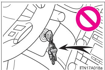
● Véhicules non dotés du système Smart key: N'accrochez pas d'objets lourds, aiguisés ou durs, par exemple des clés ou des accessoires, à la clé. Ces objets pourraient empêcher le déploiement du coussin SRS de protection des genoux ou être projetés dangereusement sur le siège du conducteur par la force du déploiement, et donc vous mettre en danger.
