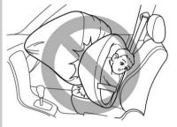
NEVER INSTALL A REARWARD FACING CHILD RESTRAINT SYSTEM ON THE FRONT PASSENGER'S SEAT, AND NEVER INSTALL A FORWARD FACING CHILD RESTRAINT SYSTEM ON THE FRONT PASSENGER'S SEAT IF THE FRONT PASSENGER'S FRONTAL AIRBAG ON INDICATOR LIGHT ILLUMINATES. DOING SO RISKS SERIOUS INJURY OR DEATH TO THE CHILD BY PLACING THE CHILD'S HEAD TOO CLOSE TO THE SRS AIRBAG.
