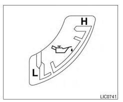
ENGINE OIL PRESSURE GAUGE (if so equipped)
