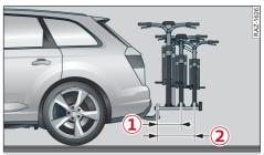
Fig. 118 Rear carrier: Maximum overhang
