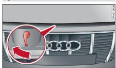
Fig. 207 Unlocked bonnet: Lever
