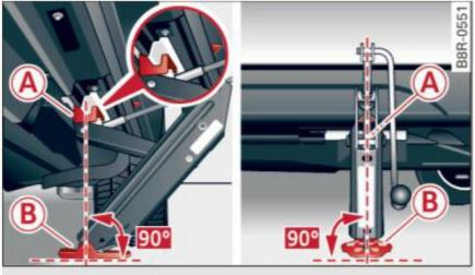
Fig. 220 Sill: positioning the jack
