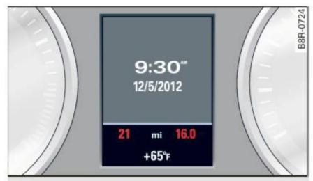
Fig. 6 Instrument cluster: odometer
