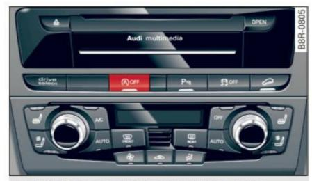
Fig. 106 Center console: Start-Stop-System button
