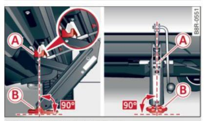
Fig. 222 Sill: positioning the jack
