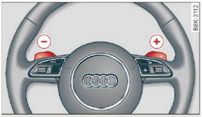
Fig. 135 Steering wheel: Shift buttons\*
