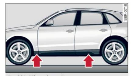
Fig. 221 Sill panels: markings
