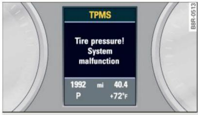
Fig. 221 Display: System malfunction
