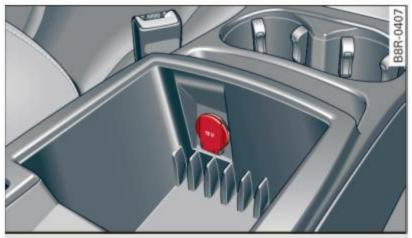
Fig. 94 Center console: 12-volt socket
