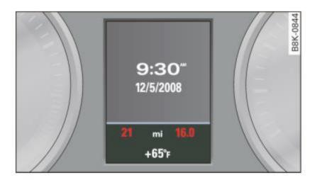
Fig. 5 Instrument cluster: odometer
