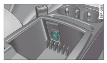
Fig. 107 Center console: 12-volt socket
