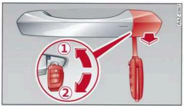
Fig. 22 Driver's door door lock cylinder
