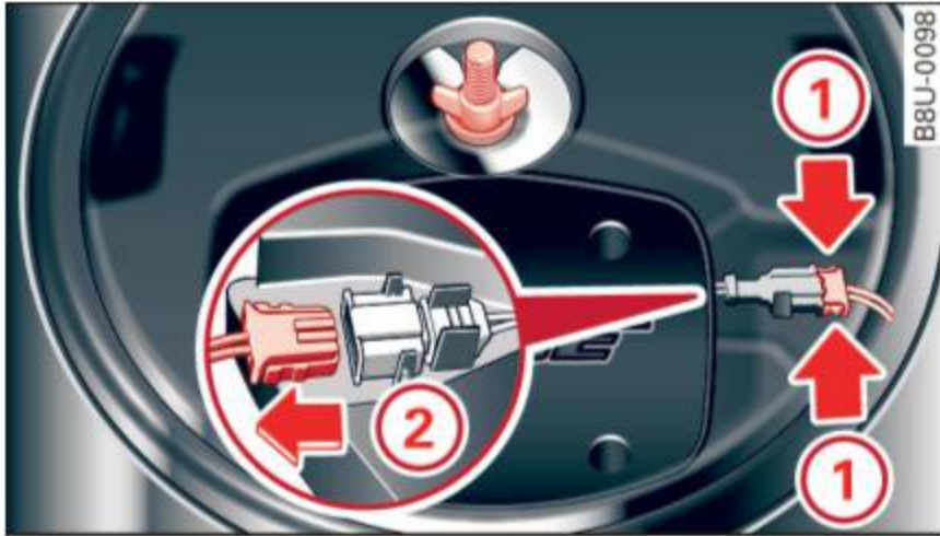
Fig. 157 Spare tire well: subwoofer
