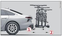
Fig. 75 Rear carrier: Maximum overhang
