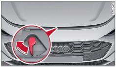
Fig. 125 Unlocked bonnet: Lever
