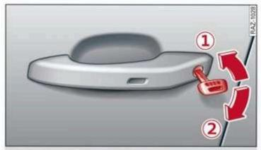
Fig. 24 Driver's door: door lock cylinder
