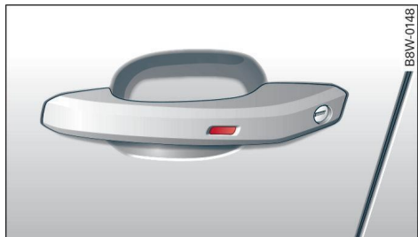
Fig. 28 Door handle: sensor for locking
