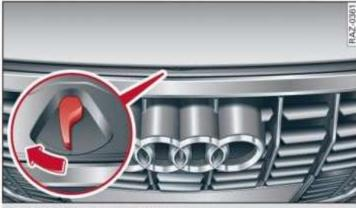
Fig. 158 Unlocked hood: lever
