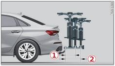
Fig. 106 Rear carrier: Maximum overhang
