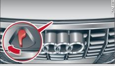
Fig. 168 Unlocked bonnet: Lever
