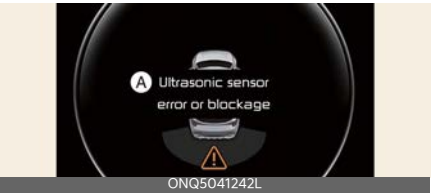
A: Ultrasonic sensor error or blockage
