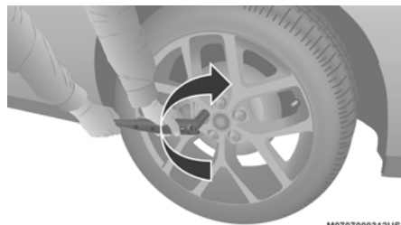
Tighten Lug Nuts
