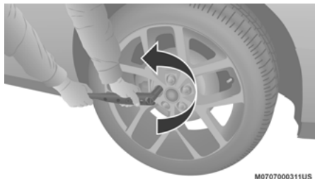
Loosen Lug Nuts
