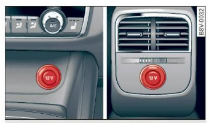
Fig. 48 Center console: front/rear 12 volt socket
