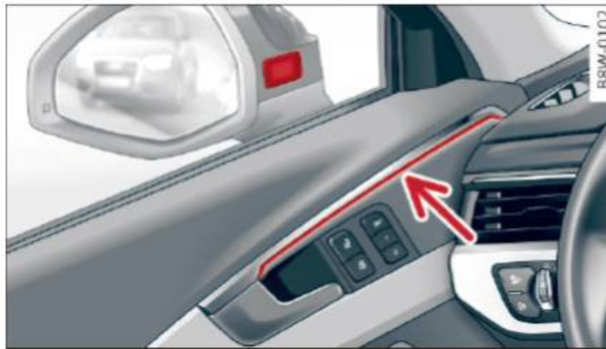
Fig. 114 Door: warning strip
