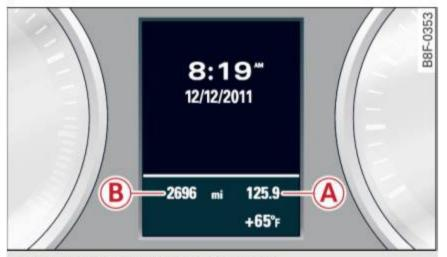
Fig. 5 Instrument cluster: odometer
