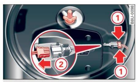
Fig. 161 Spare wheel well: subwoofer
