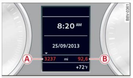
Fig. 4 Instrument cluster: odometer
