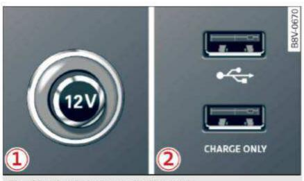
Fig. 65 12 volt socket and USB ports\*
