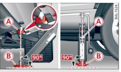
Fig. 265 Sill: positioning the jack
