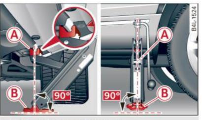
Fig. 264 Sill: positioning the jack
