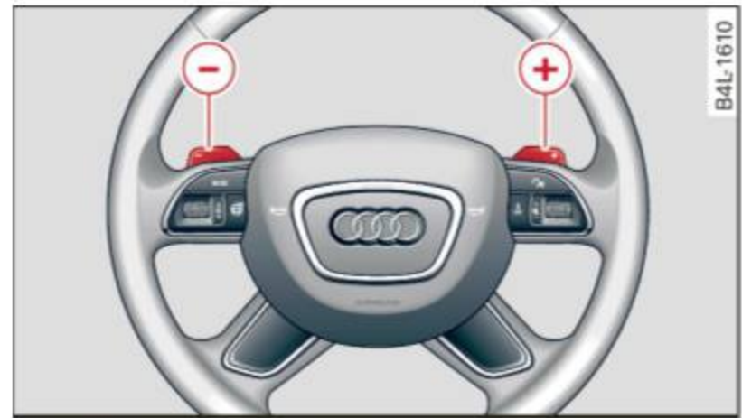
Fig. 162 Steering wheel: Shift buttons
