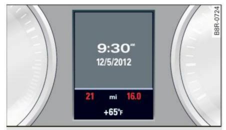
Fig. 6 Instrument cluster: odometer
