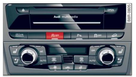
Fig. 106 Center console: Start-Stop-System button
