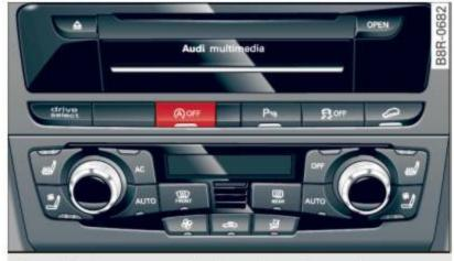
Fig. 104 Center console: Start-Stop-System button
