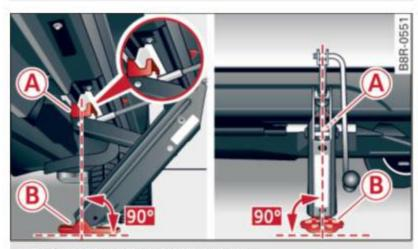
Fig. 220 Sill: positioning the jack
