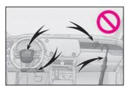
Ne fixez rien à des emplacements tels que les portes, la vitre du pare-brise, les vitres latérales, les montants avant ou arrière, des rails latéraux de toit et des poignées de maintien.
