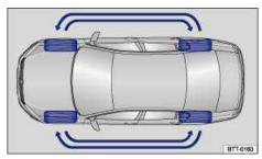
Fig. 119 Tire rotation diagram.
