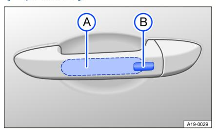
Fig. 45 In door handle: sensors.
