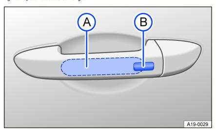
Fig. 47 In door handle: sensors.
