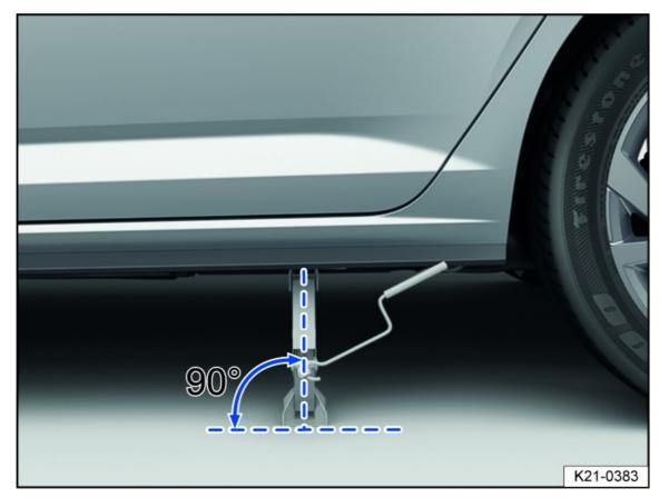
Fig. 187 Correct jack setup (variant 2).
