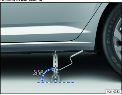
Fig. 183 Correct jack setup (variant 2).
