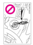
N'accrochez pas d'objets lourds, aiguisés ou durs, par exemple des clés ou des accessoires, à la clé. Ces objets pourraient empêcher le déploiement du coussin SRS de protection des genoux ou être projetés dangereusement sur le siège du conducteur par la force du déploiement, et donc vous mettre en danger.
